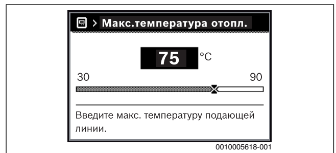
Рис. 25 Установка максимальной температуры подающей линии
