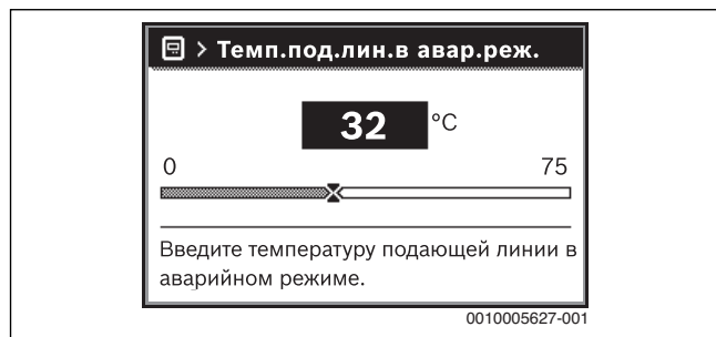
Рис. 42 Температура подающей линии для аварийного режима
